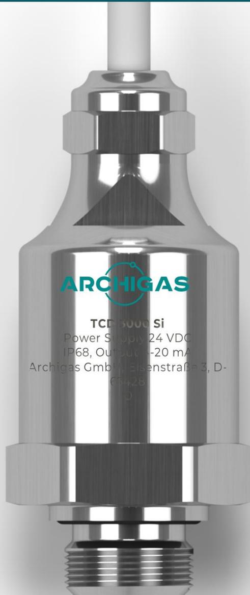
Der kompakte und robuste TCD3000 Si (Screw-in) eignet sich hervorragend für die präzise, schnelle und empfindliche Messung von (quasi-)binären Gasgemischen. Die Messung basiert auf dem Prinzip der Wärmeleitfähigkeit. Diese Technologie ist ideal für die Messung von Gasen mit stark unterschiedlichen Wärmeleitfähigkeiten, wie zum Beispiel H<sub>2</sub> und O<sub>2</sub>.
